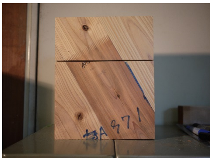
試験後 ラミナ幅はぎ部亀裂(裏側)
