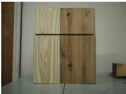
試験後 亀裂なし(裏側)
