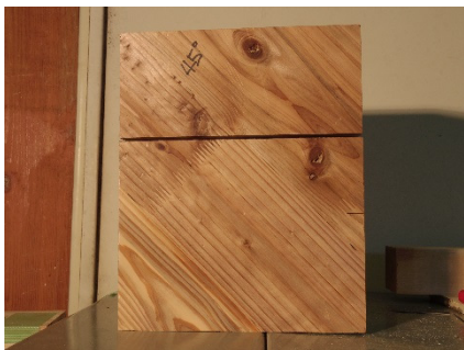
試験後 亀裂なし(裏側)
