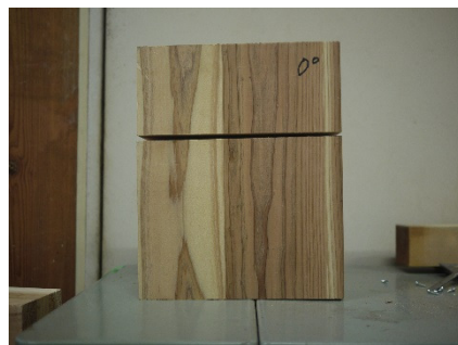
試験後 亀裂なし(裏側)
