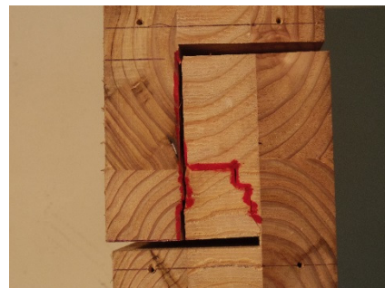
ひき板境目にて亀裂(CH2 側)
