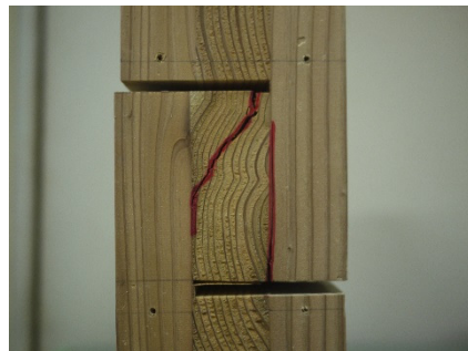
直行層内部 45° 方向に亀裂(S1)
