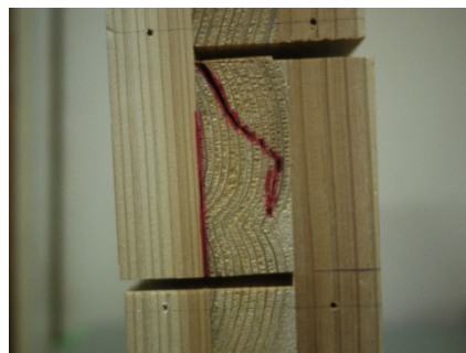
直行層内部 45° 方向に亀裂(S2)
