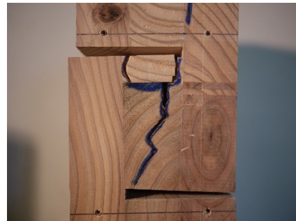
接着面, 45 度面に沿って亀裂(CH1 側)
