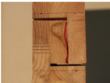
接着面に沿って亀裂(CH1 側)
