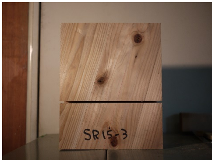
試験後 亀裂なし(表側)
