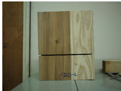
試験後 亀裂なし(表側)
