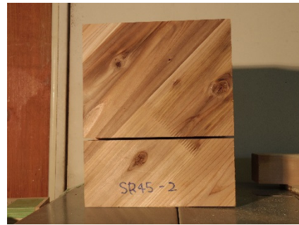
試験後 亀裂なし(表側)
