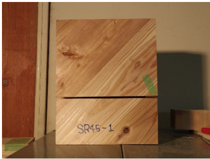
試験後 亀裂なし(表側)
