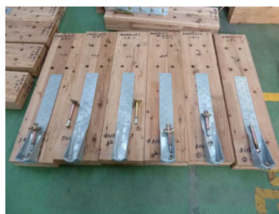
図 2.5.2 -13 文献①における壁－基礎ボルト実験
