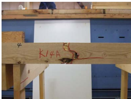
写真 3.5 節による破壊
