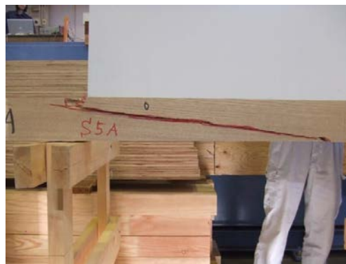
写真 3.6 繊維傾斜による破壊
