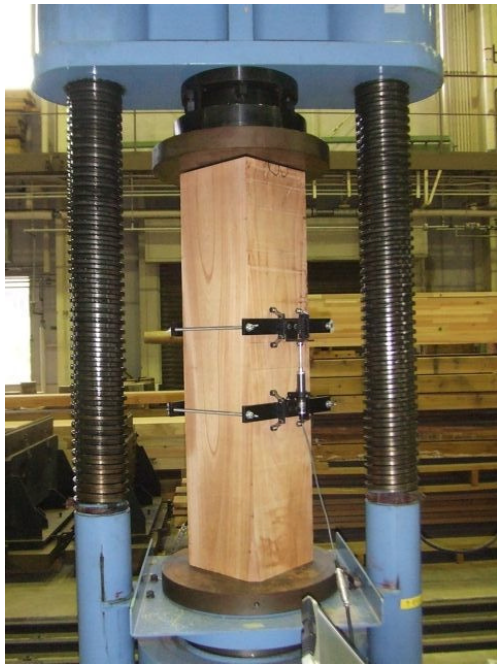
写真 3. 2. 2-1 実大縦圧縮試験の様子
