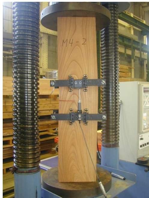
写真 3. 2. 2-2 試験後の様子（赤線が破壊部分）
