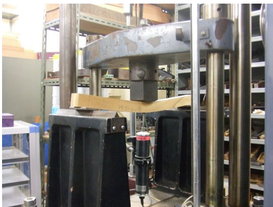
写真 3. 2. 3-1 無欠点小試験体の曲げ試験の様子
