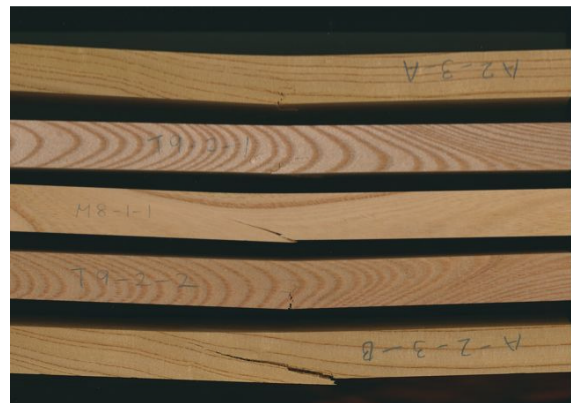
写真 3. 2. 3-2 破壊後の試験体の例
