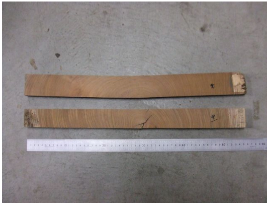
写真 3.2.3-3 ケヤキ板材の木口断面 (上：試験体 No.1、下：試験体 No.2)
