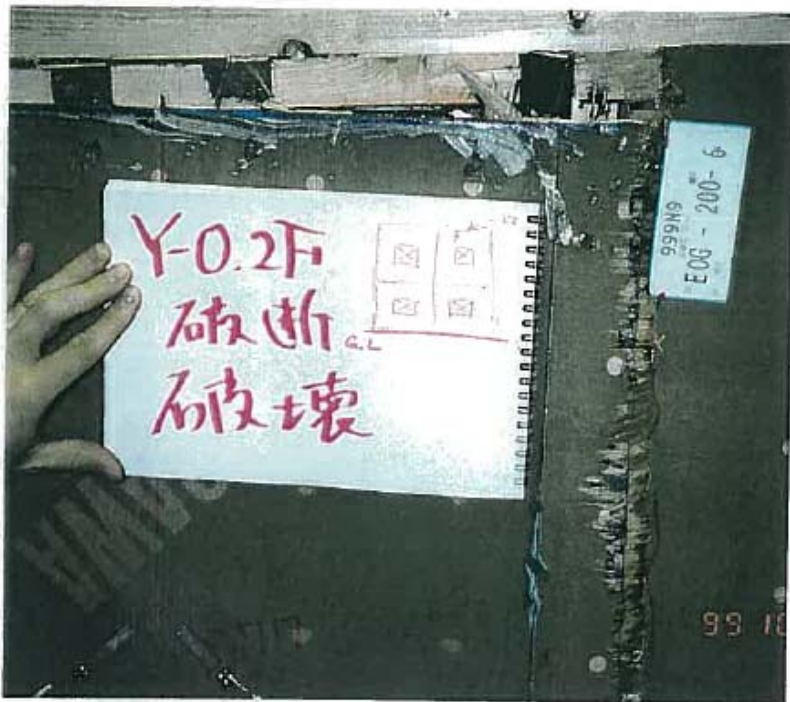
写真 10 小壁パネルのせん断破壊。(WoY 0 5, WoY 0 6)
