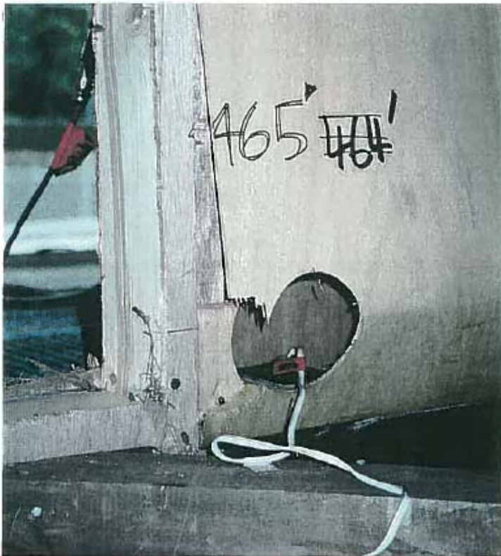
写真7 合板がせん断破壊した。(WiX 8 4)
