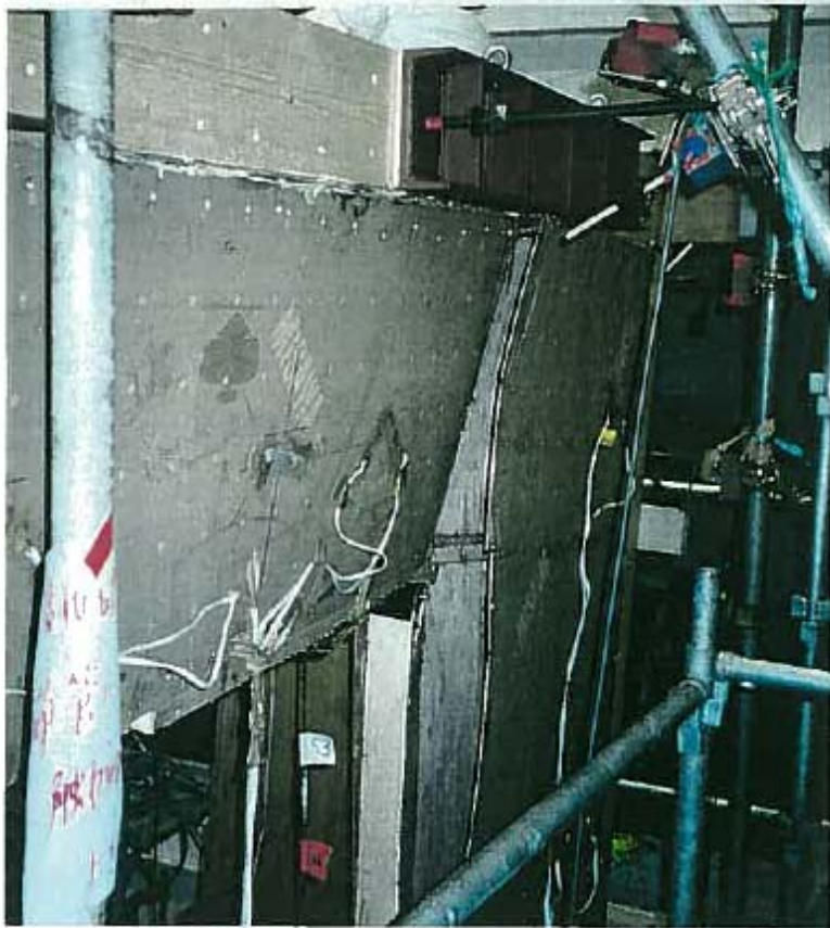
写真 13 壁パネルの面外座屈。(WoX 8 2, WoX 0 3)
