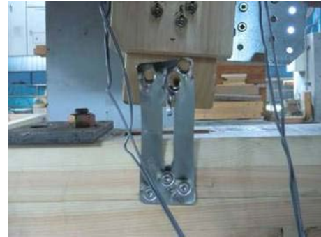
写真 9.1-1 接合部金物の破壊
