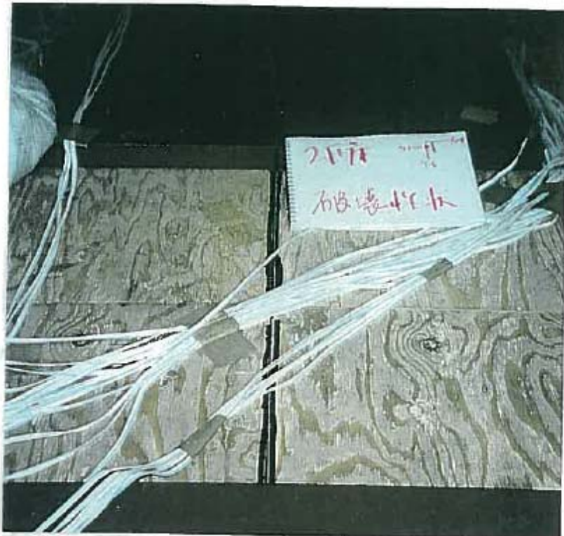
写真8 床パネル間が剥離した。(F2F5, F2F6)
