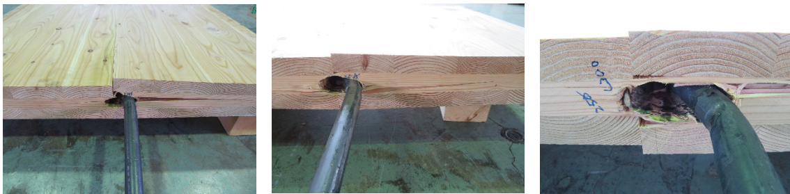
図 1-1. 5. 11 試験終了後の状態 (カラマツ、径 25mm)
