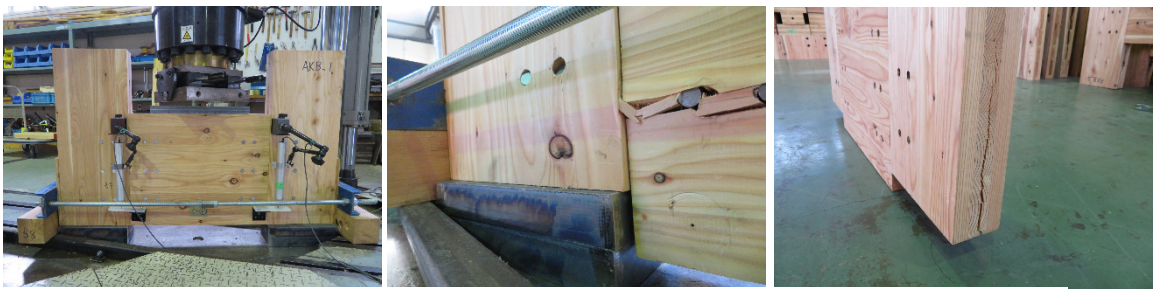
図 1-1.1.12 試験終了後の様子 (カラマツ、逆方向)
