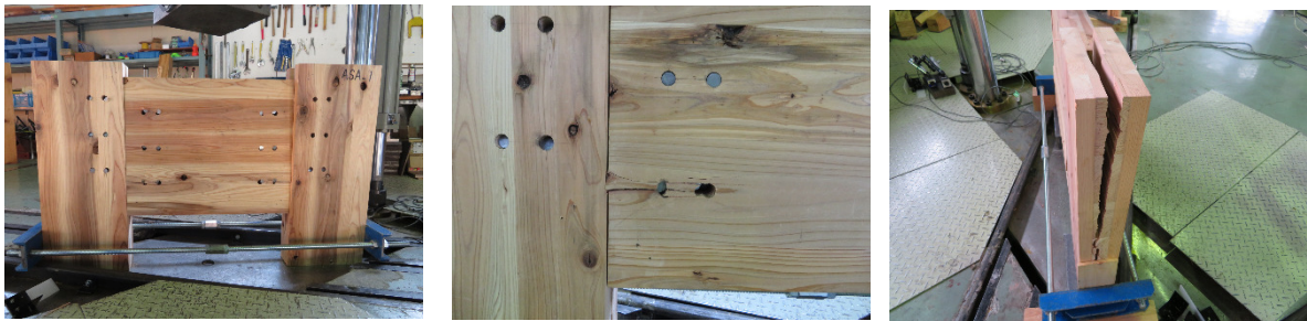
図 1-1.1.7 試験終了後の状態 (スギ、順方向)
