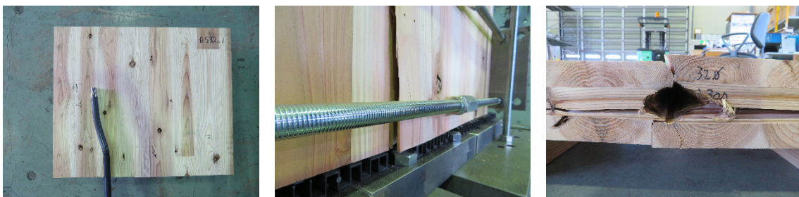
図 1-1. 5. 10 試験終了後の状態 (スギ、径 32mm)
