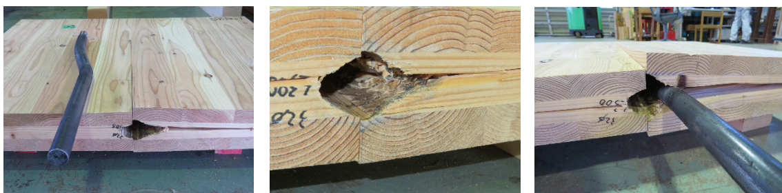
図 1-1. 5. 12 試験終了後の状態 (カラマツ、径 32mm)
