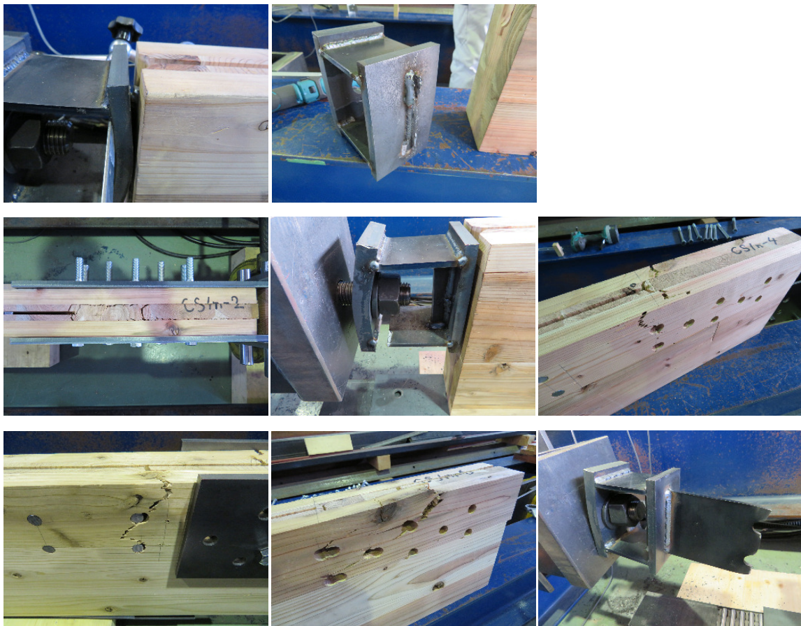
図 1-1.3.12 試験終了後の状態 (スギ、ドリフトピン 8 本)
