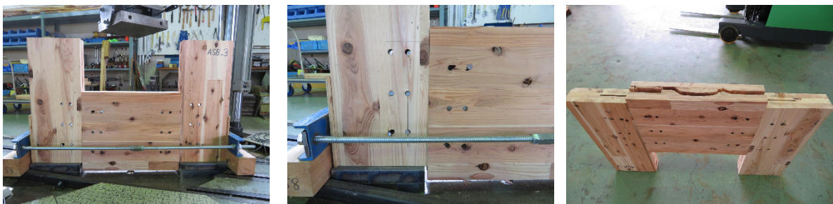
図 1-1.1.8 試験終了後の状態 (スギ、逆方向)
