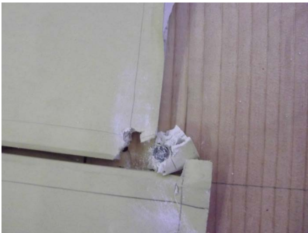
せっこうボード隅角部の欠け (4.1×38mm 一方向)
