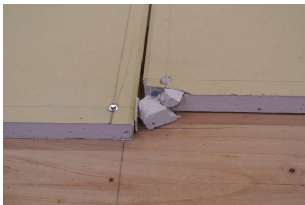
4.8×50mm 一方向 ボードの欠け
