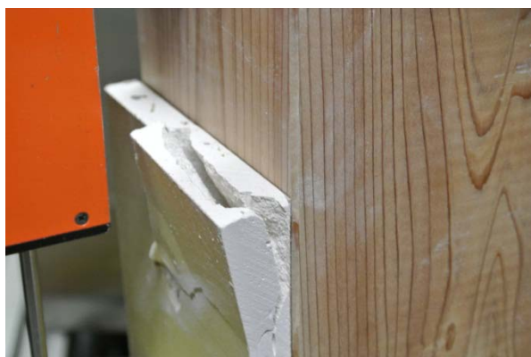
4.8×50mm 一方向 ボードの割れ
