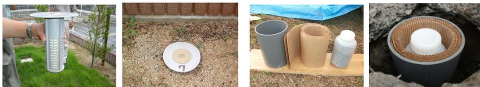
ベイト容器部材の例    ベイト容器埋設状態    回収型容器の例    回収型容器の埋設状態
