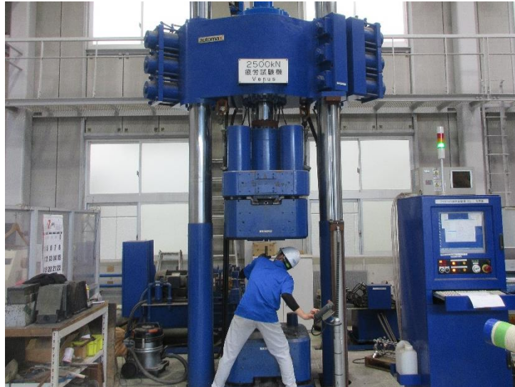
写真 3.1 : 2500kN 疲労試験機(ビーナス)
