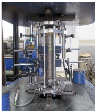
写真 3.2 : 変位計取付器具
