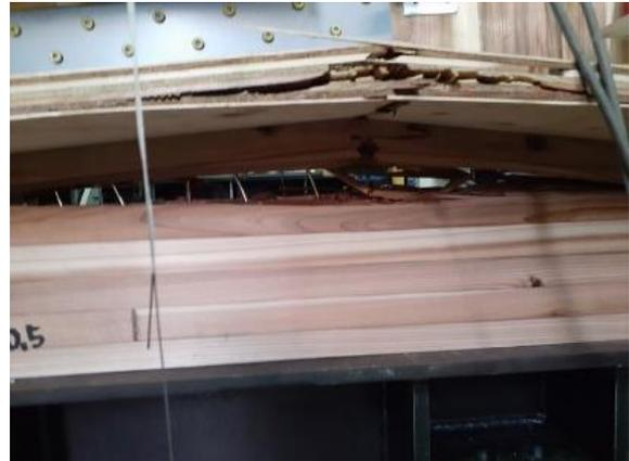
写真 2.2.4.2 集成材梁の割裂 2
