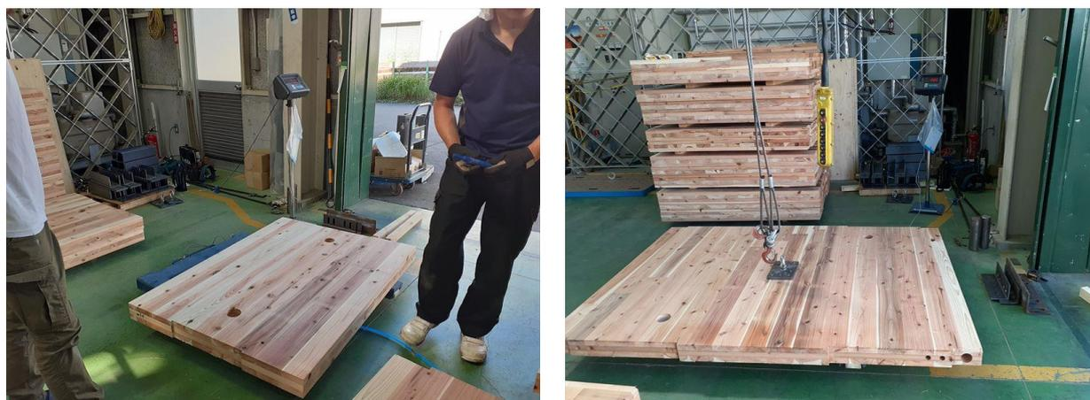
写真 2.3.1.1 CLT 壁パネル 質量測定状況
