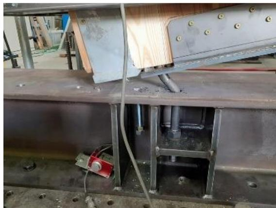
写真 2.3.4.2 M16 ボルト破断
