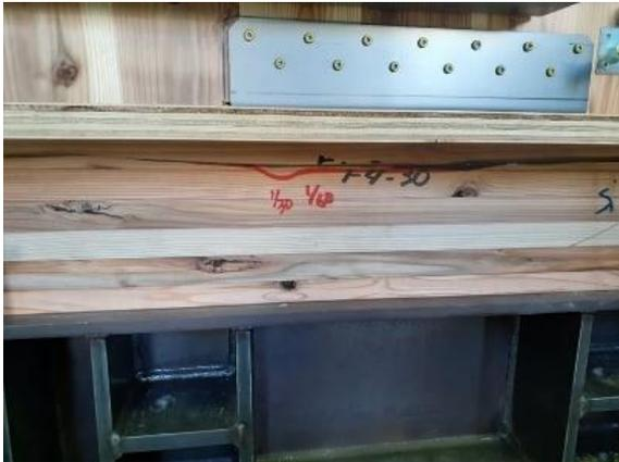
写真 2.2.4.1 集成材梁の割裂 1
