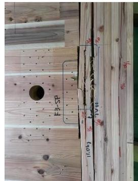
構造用集成材と CLT 壁パネル 破壊状況
