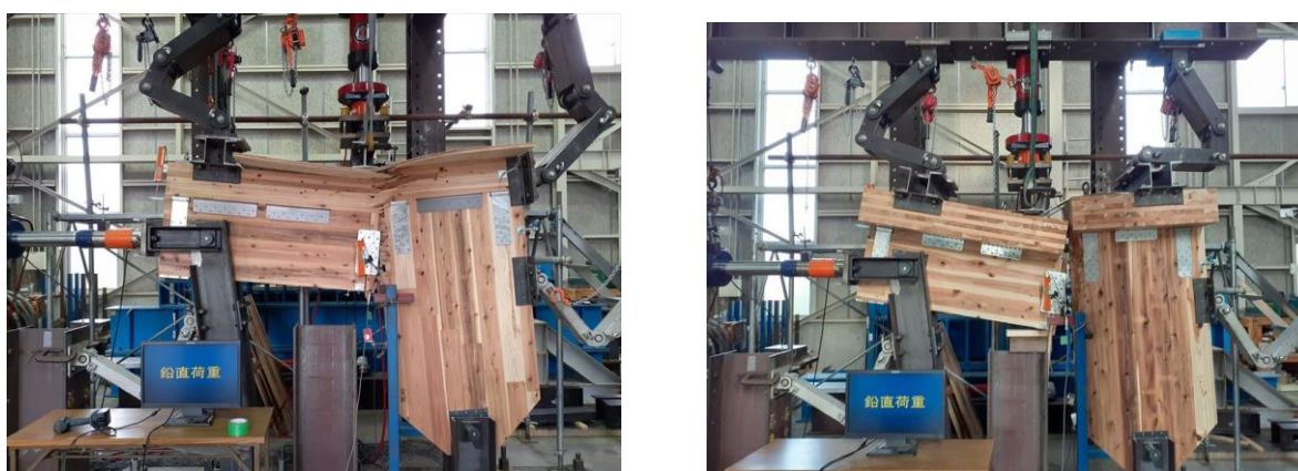
写真 3.3.2 鉛直荷重載荷状況
