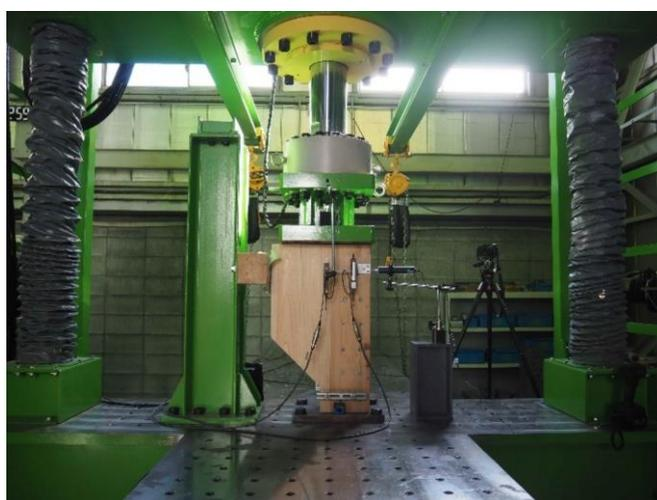
図5.3-12 圧縮実験 試験体・変位計設置状況
