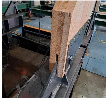
写真 4.2.1.2 壁脚接合部(試験体 G,C 共通)
