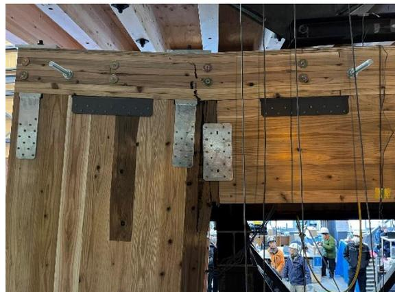
写真 4.4.4.6 集成材梁折損 垂壁端部開き
