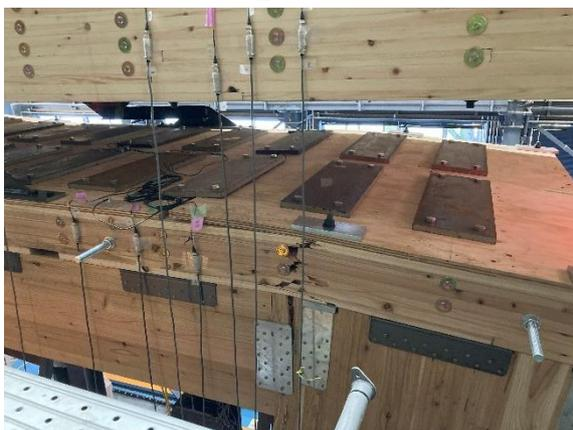
写真 4.4.4.11 集成材梁折損 垂壁端部めり込み
