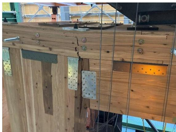
写真 4.4.4.10 集成材梁折損 垂壁端部開き
