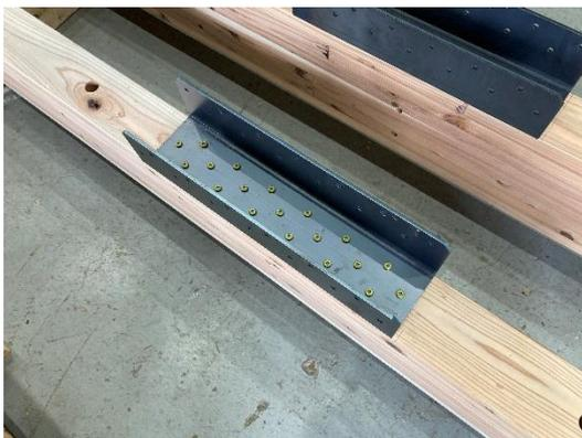
写真 4.2.1.5 コの字製作金物(試験体 G,C 共通)
