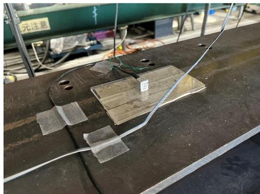
写真 4.2.4.2 架台上加速度計
