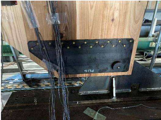
写真 4.2.1.1 壁脚接合部(試験体 G,C 共通)
