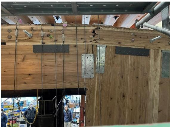
写真 4.4.4.5 集成材梁折損 垂壁端部めり込み
