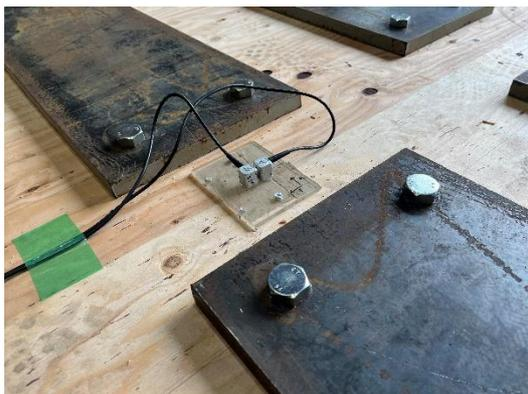
写真 4.2.4.1 試験体床上加速度計
