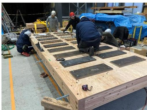
写真 4.2.3.3 錘設置状況(試験体 G)
