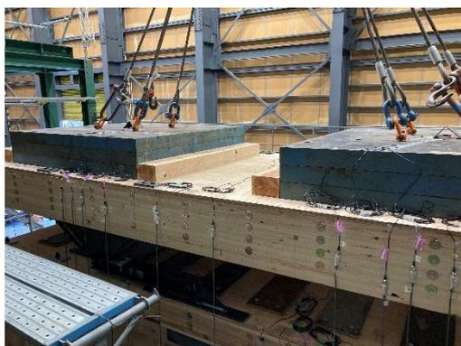
写真 4.2.3.1 錘設置状況(加力フレーム)
