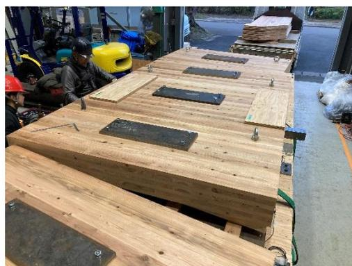
写真 4.2.3.4 錘設置状況(試験体 C)
