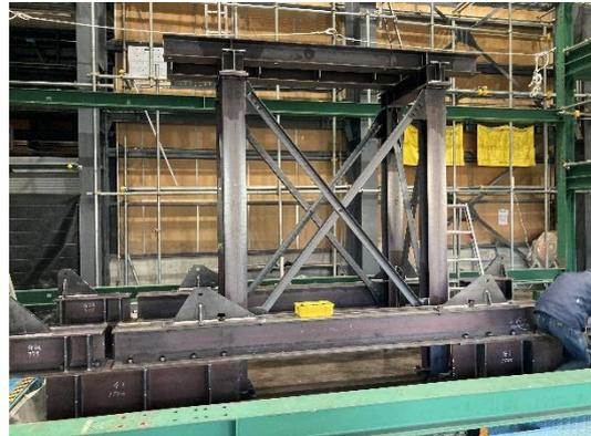
写真 4.2.2.4 鉄骨槽(試験体 G,C 共通)
