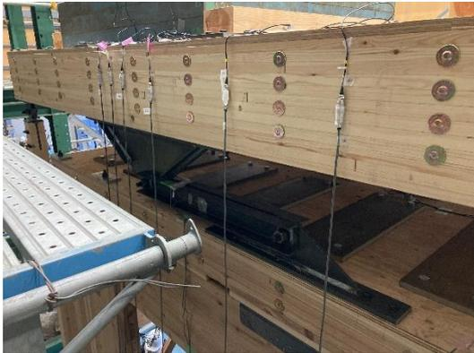
写真 4.2.2.3 接統治具(試験体 G,C 共通)
