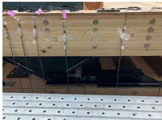
写真 4.2.4.10 垂壁パネルひずみゲージ
