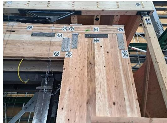
写真 4.2.1.4 壁脚接合部(試験体 C)
