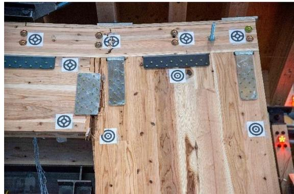
写真 4.4.4.4 集成材梁折損 垂壁端部開き
