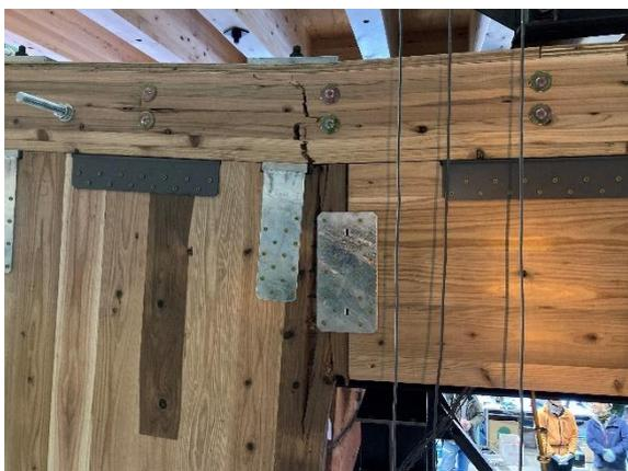
写真 4.4.4.9 集成材梁折損 垂壁端部開き
