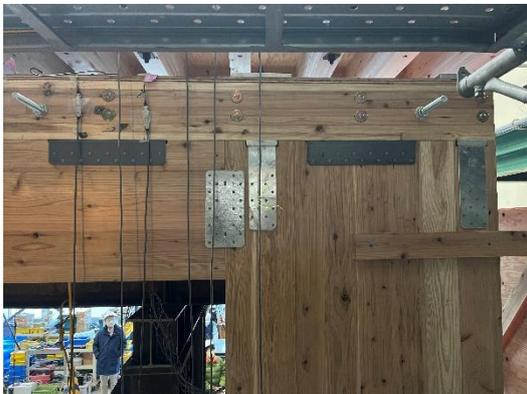
写真 4.2.1.3 壁脚接合部(試験体 G)
