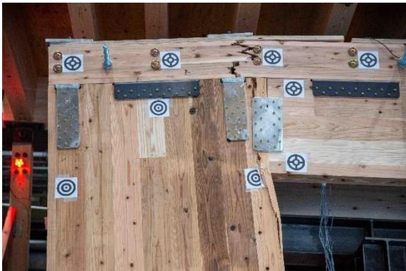
写真 4.4.4.3 集成材梁折損 垂壁端部めり込み
