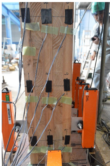
G 圧縮側脚部断面(試験前)
