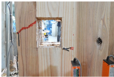
G ボルト穴・裏(試験後)
