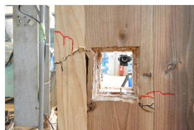
F ボルト穴・裏(試験後)
