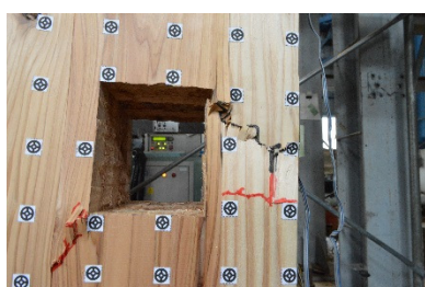
D ボルト穴・表(試験後)
