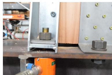
C 左側脚部浮上がり (試験後)
