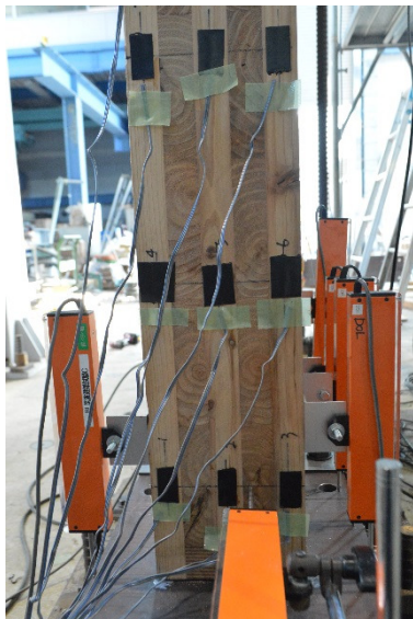
G 圧縮側脚部断面(試験前)
