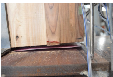
H 圧縮側脚部・表 (試験後)
