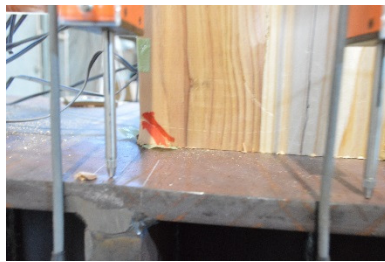
H 圧縮側脚部・裏(試験後)
