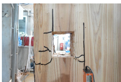
G ボルト穴・裏 (試験後)
