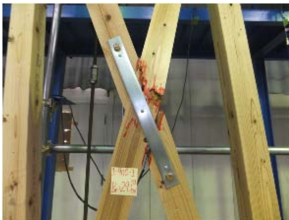
写真 14. 4-3 1-90C-1 筋かい交差部の座屈
