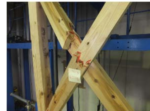
写真 14. 4-18 2-90C-3 引張筋かいの引張破断、圧縮筋かいの座屈
