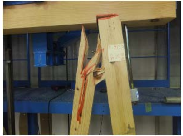
写真 14. 4-8 1-90C-3 圧縮筋かい端部の割れ
