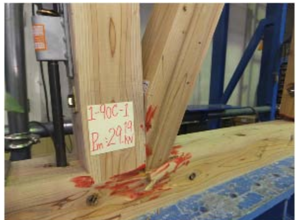
写真 14. 4-2 1-90C-1 筋かい端部のめり込み
