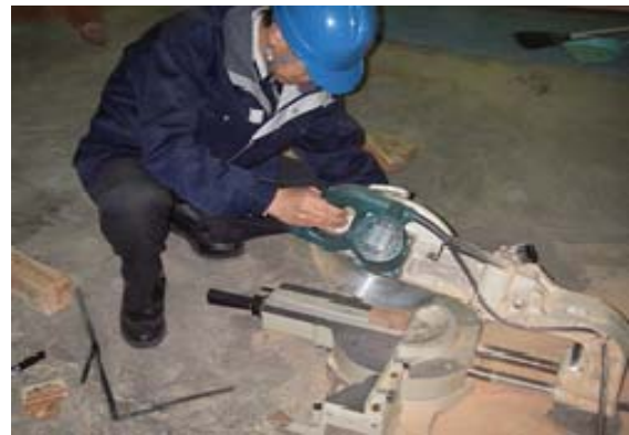
写真 2.5.2 試験材から試験片採取状況
