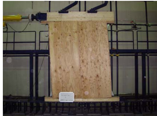
写真 2.4.2 試験終了時の状況((2級-4)
