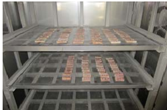
写真 2.5.4 試験片の乾燥工程
