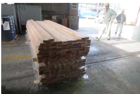
写真 2.2.8 モルダー加工済みの試験材
