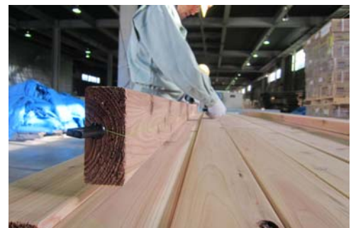
写真 2.2.9 グレーダーによる格付作業
