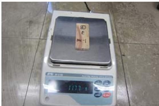
写真 2.5.3 試験片の重量測定
