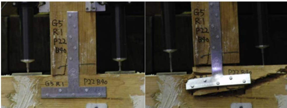
写真 5.1 菌床による劣化操作した試験体の一例
