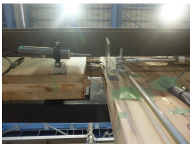
F 入隅部から亀裂 (試験終了時)
