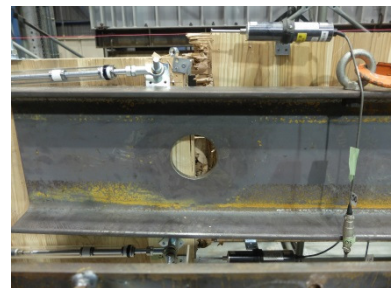
E 入隅部から破断 (試験終了時)
