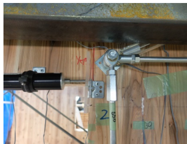
D 入隅部から亀裂 (1/75rad 押)
