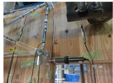
B 入隅部から亀裂 (1/75rad 引)
