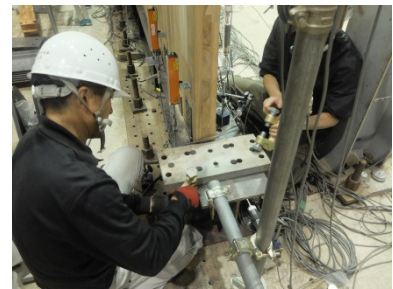
B すべり防止プレートの設置
