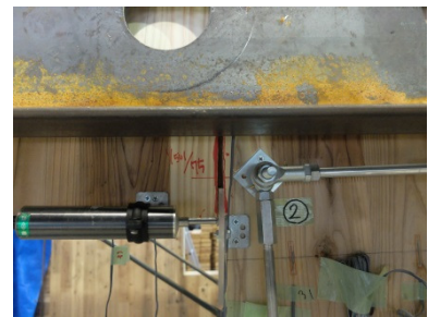
B 入隅部から破断 (1/50rad 押)
