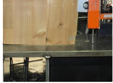
右下めり込み(引き切り)
