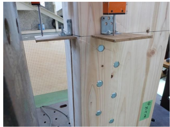
ドリフトピン最上部 圧縮破壊
