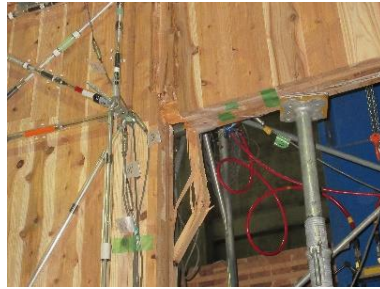
(5) 開口部左上亀裂(引き切り)
