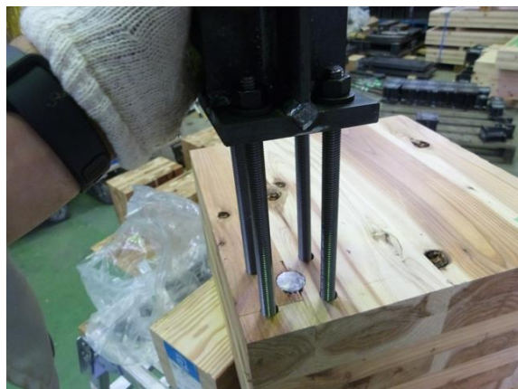
写真 2.5.2.2.1 試験体組立状況 (圧縮試験体)
