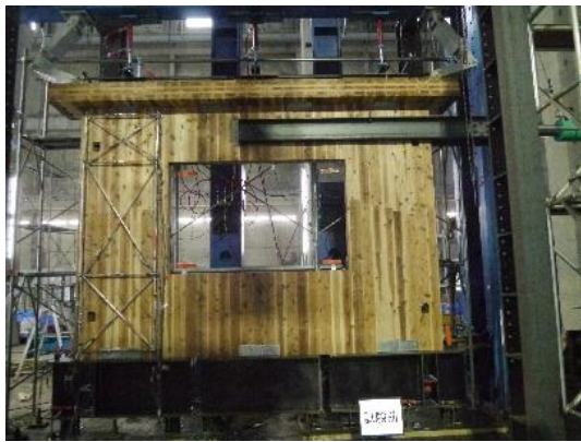
写真 2.5.1.4.11 試験体全景(加力前)
