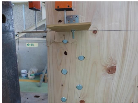
ドリフトピン最上部 圧縮破壊
