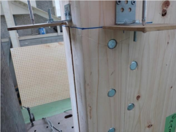
加力点圧縮破壊
