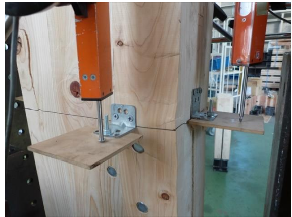
ドリフトピン最上部 圧縮破壊
