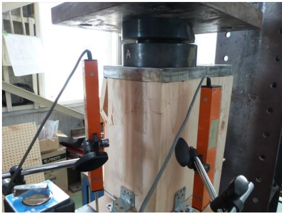
加力点圧縮破壊
