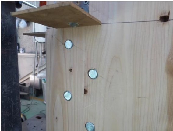
ドリフトピン最上部 圧縮破壊
