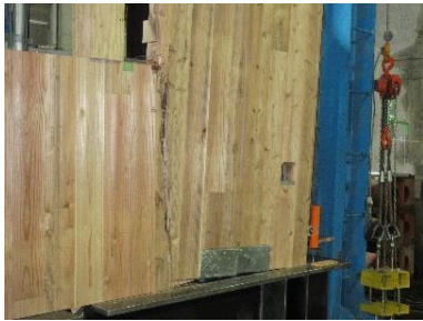
開口部(右下)破断(試験終了時)
