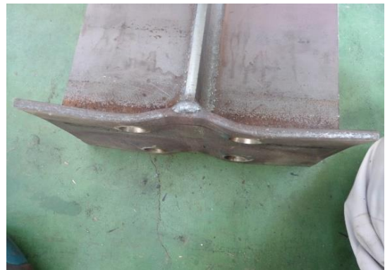
3 体目 鋼製梁底部の変形
