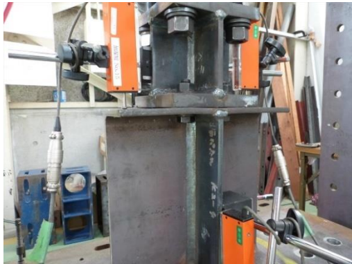
2 体目 壁端接合金物と鋼製梁
