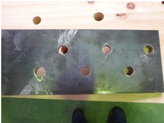
鋼板孔部 支圧変形
