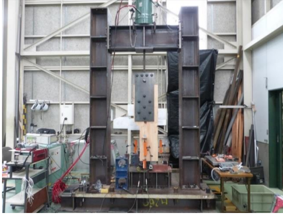
写真 2.5.2.1.2 引張試験状況
