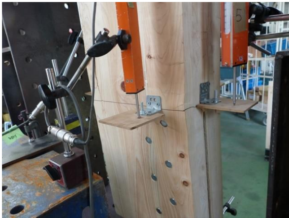
ドリフトピン最上部 圧縮破壊
