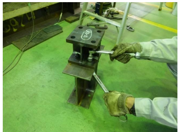
写真 2.5.2.3.1 試験体組立状況及び接合ボルト
