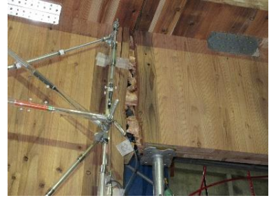
開口部(左上)破断(試験終了時)
