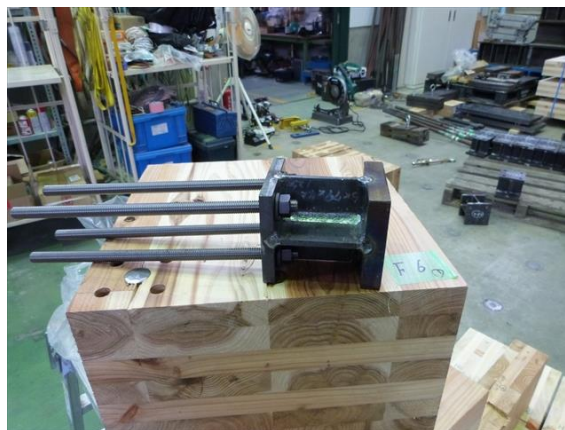
写真 2.5.2.2.1 試験体組立状況 (圧縮試験体)
