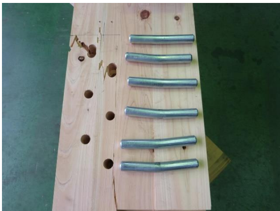
ドリフトピンの曲げ変形及び木部せん断破壊
