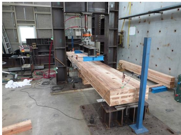
写真 2. 5. 1. 4. 13 曲げ試験実施状況
