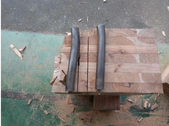
CLT 上面及び壁端金物状況 圧縮抵抗棒の座屈
