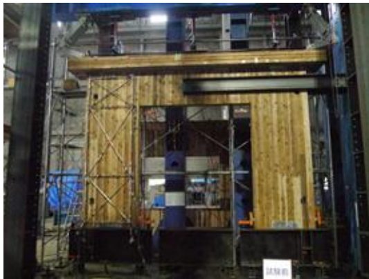
写真 2.5.1.4.7 試験体全景 (加力前)
