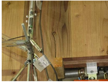
開口部(左上)から亀裂(-1/50 押)
