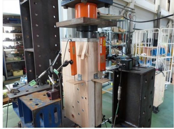
加力点圧縮破壊
