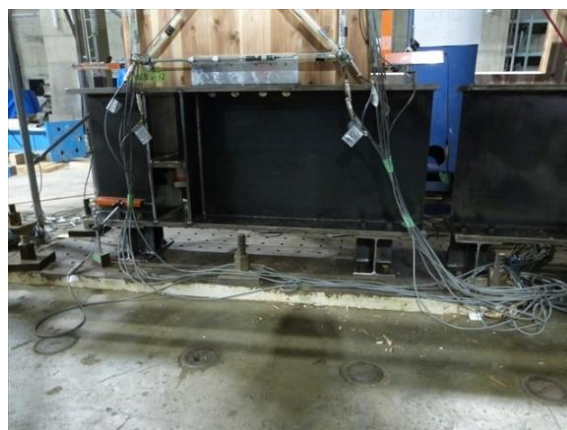
壁パネル 150mm 三分力計→H形鋼変更
