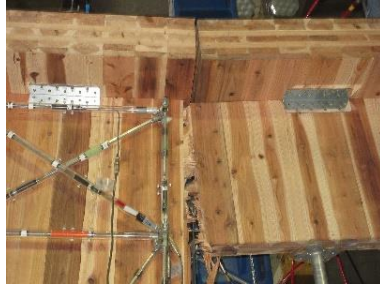
開口部左上破断(試験終了時)
