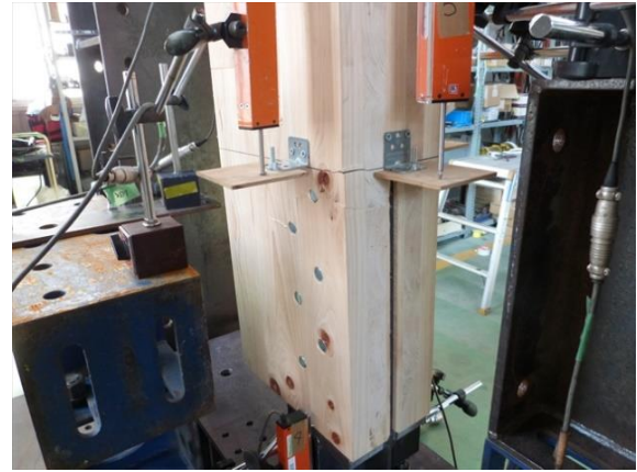
ドリフトピン最上部 圧縮破壊
