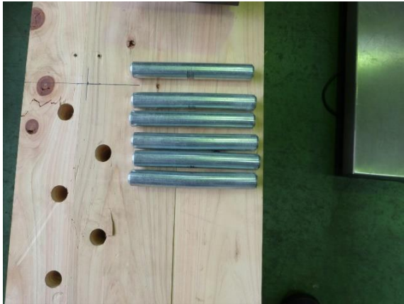
ドリフトピン 状況
