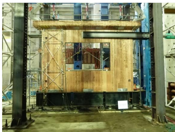
窓開口試験体
