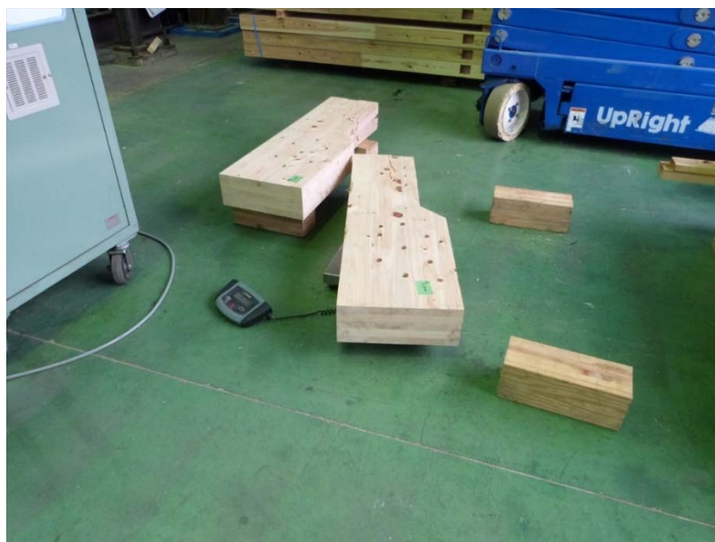
写真 2.5.2.1.1 CLT 質量測定状況の例 (引張試験体)
