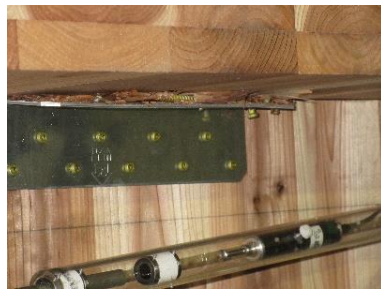
L字金物ビスせん断 写真 2.5.1.4.12 破壊性状(015b)
