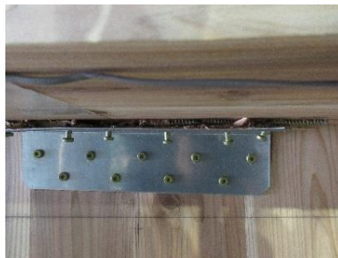
L型金物ビスせん断 写真 2.5.1.4.8 破壊性状(C15a)
