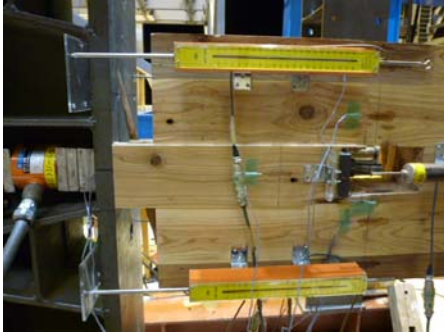
写真 2.3.2 最外層ラミナのせん断破壊
